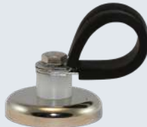
BASE MAGNÉTICA PARA LÍNEA PILOTO. SE ADAPTA A MANGUERA DE 1/2" (DIÁMETRO EXTERIOR DE 20 MM A 22 MM) FUERZA DE TRACCIÓN DE 68 KG (150 LB) MF104074
