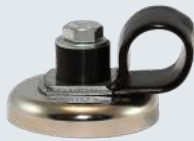
BASE MAGNÉTICA PARA LÍNEA PILOTO - SE ADAPTA A MANGUERA DE 3/8" (DIÁMETRO EXTERIOR DE 16,5 MM A 18 MM) FUERZA DE TRACCIÓN DE 68 KG (150 LB) MF104073
